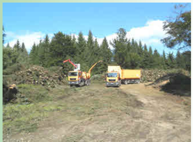
Das Energieholz wird üblicherweise nach der Ernte bis an den nächsten Abfuhrweg gerückt und später mit einem Hacker zu Hackspänen verarbeitet und abtransportiert.
