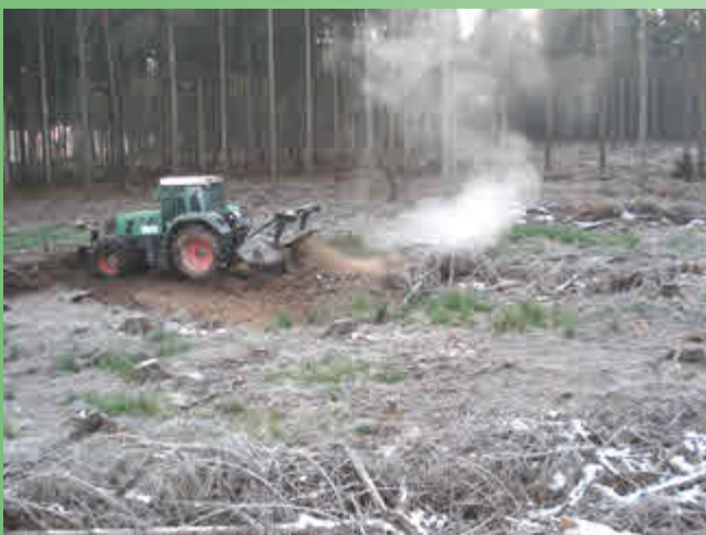
Mulchereinsatz auf einer Windbruchfläche nach der Holzernte
