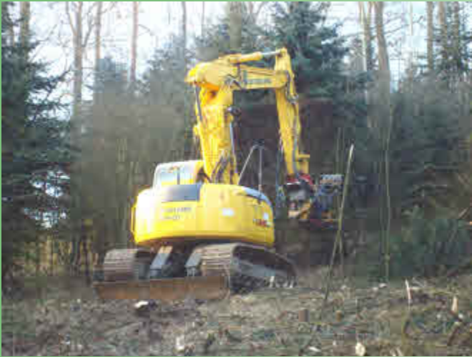
Kettenbagger (15 to.) mit ca. 8 Meter Auslage bei der Energieholzente im Forstrevier Chemnitz
