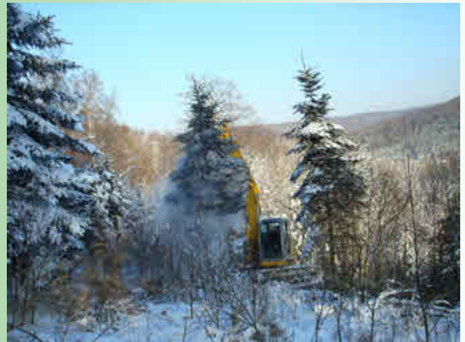
Kettenbagger (15 to.) mit ca. 8 Meter Auslage bei der Energieholzente im Forstrevier Chemnitz
